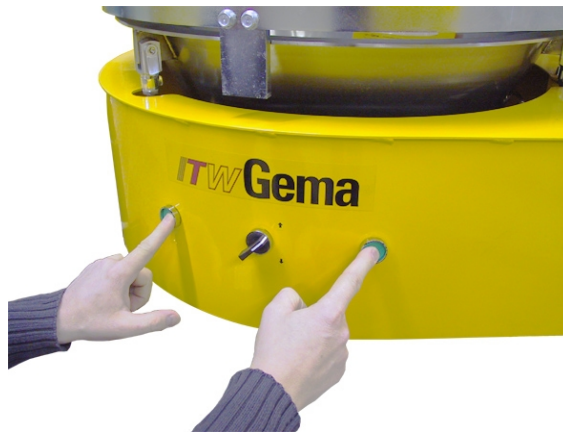
Двуручная безопасная эксплуатация подающего устройства
